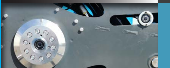
Système à 2 caméras - pour l'alignement des moyeux et des boulons
