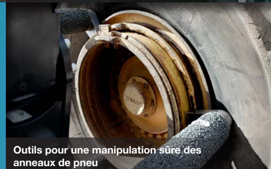
Bras à sommet plat pour un dégagement limité des pneus
